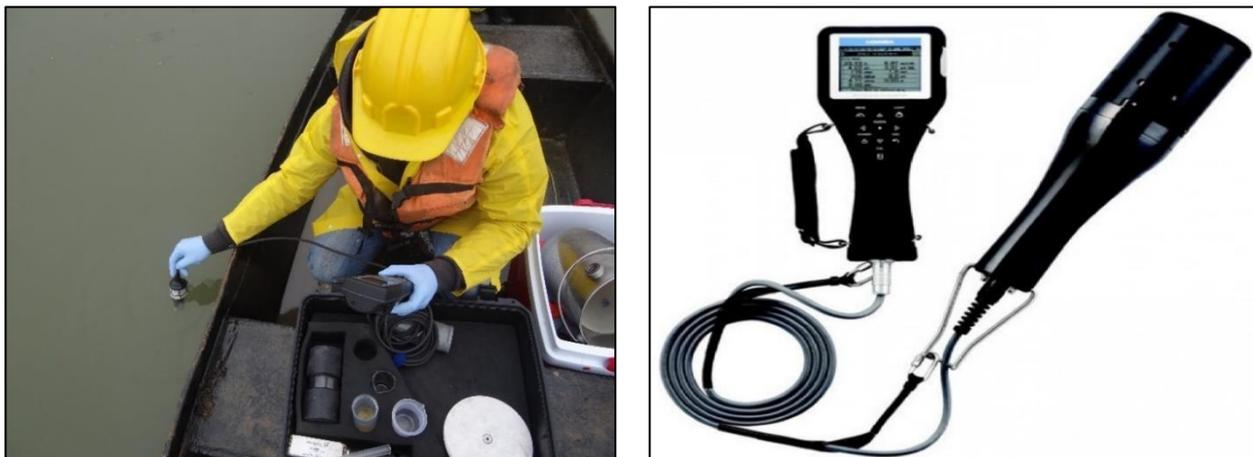
**Figura 04. Exemplos de equipamentos multiparâmetro.**
