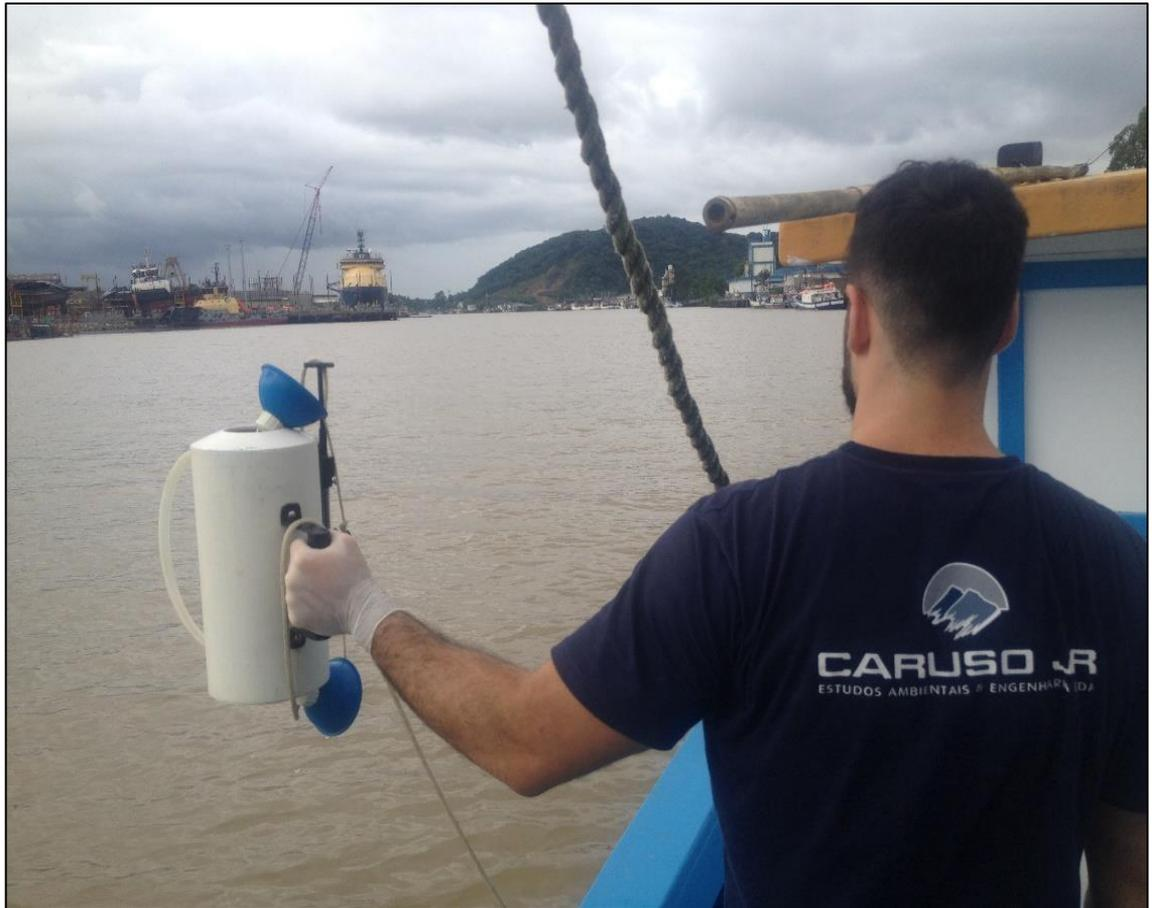
**Figura02. Exemplo de amostrador do tipo Van-Dorn.**
