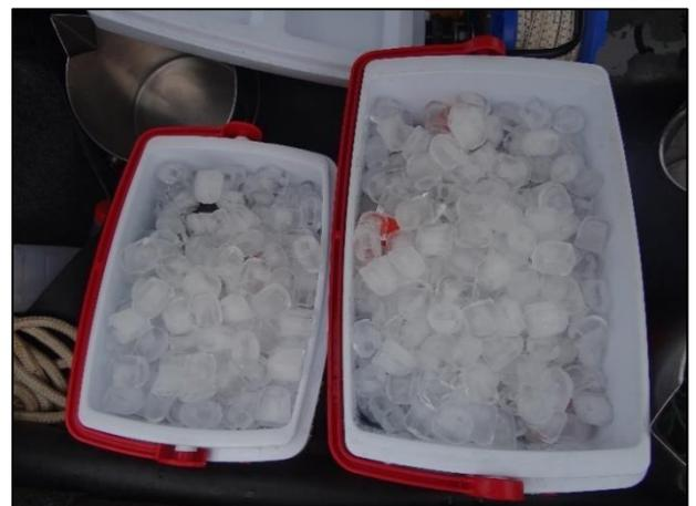
**Figura 03. Exemplo de acondicionamento dos frascos após a coleta de água superficial.**
