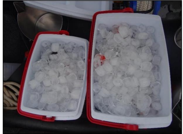
Figura 13. Exemplo de acondicionamento dos frascos após a coleta de água superficial.
