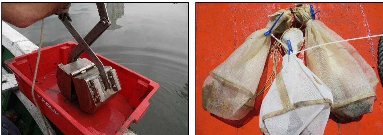
**Figura 15. Exemplo de draga Van Veen empregada nas coletas de organismos bentônicos de substrato inconsolidado (à esquerda) e amostra acondicionadas em sacos de tela devidamente identificados (à direita).**
