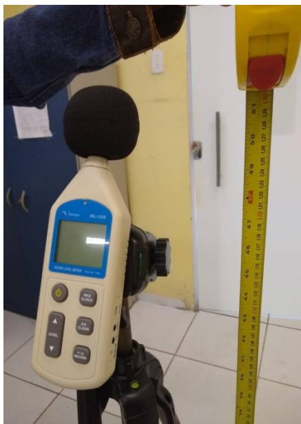
Imagem 06: Decibelímetro usado na análise de ruído.
