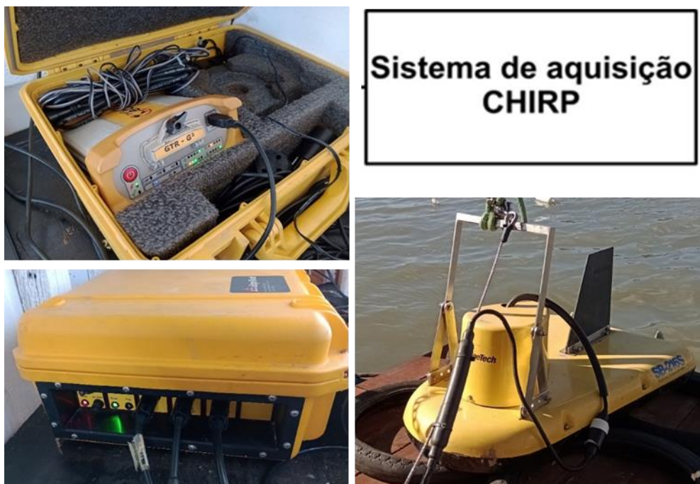
Figura 2 – Sistema de aquisição CHIRP. (A) GPS. (B) Caixa coletora. (C) Perfilador SB216S.
