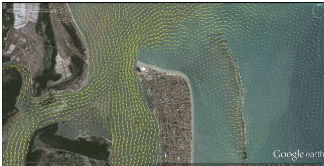
Figura 19: Campo vetorial de correntes para um instante de maré vazante.
