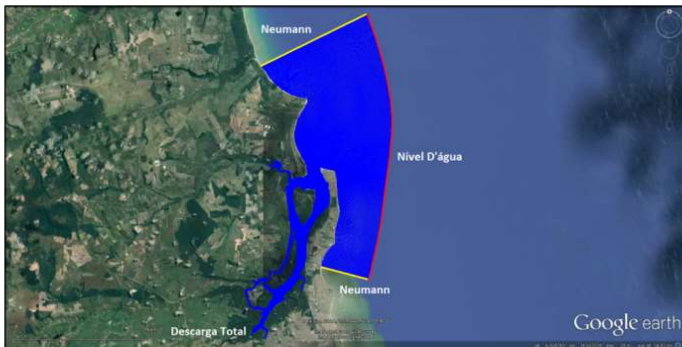
Figura 16: Esquematização das condições de contorno na grade numérica do modelo hidrodinâmico implementado na região de Cabedelo.
