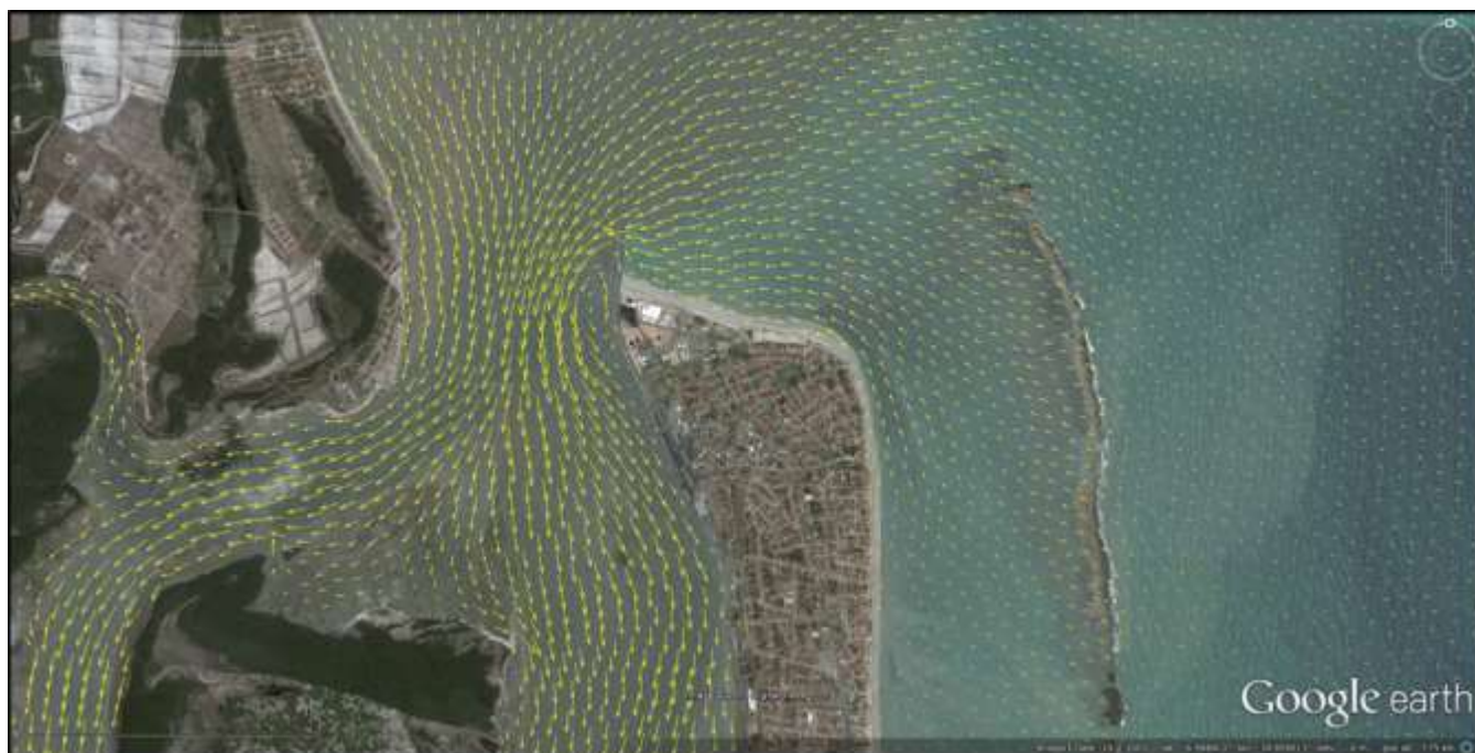
Figura 20: Campo vetorial de correntes para um instante de maré enchente.
