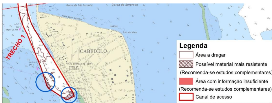
Figura 3-20 - Os círculos em azul mostram áreas nas quais já era esperada a ocorrência de materiais com maior dificuldade à remoção mecânica, podendo demandar a necessidade de desmonte por métodos alternativos de dragagem (Fonte: INPH, 2017).
