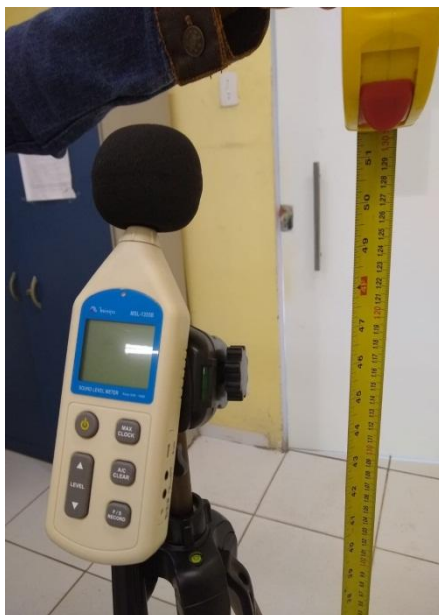
Imagem 06: Decibelímetro usado na análise de ruído.
