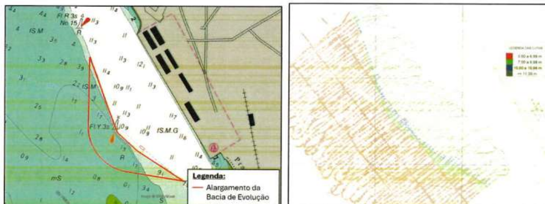
Figura 3: Poligonal de Dragagem da Bacia de Evolução Sobre Carta Náutica e Levantamento Batimétrico PB-DPB-25.01.0-310-EIC-001 – Elaborado pela empresa EICOMNOR (Fonte: Elaboração Própria)
