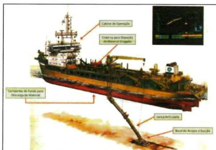
Figura 14: Ilustração de Draga TSHD em Operação (Fonte: IHC)
